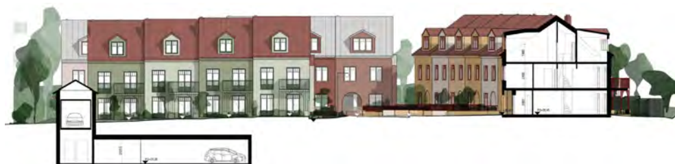
Sektion genom radhusområdet. I sektionen syns garaget under radhusen. Bild: APH Arkitekter.
