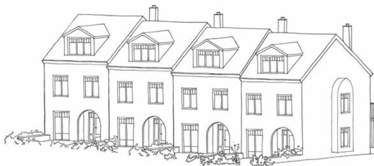
Schematisk skiss på förskjuten sammanfogning av radhusenheter med trappning Bild: APH arkitekter.
