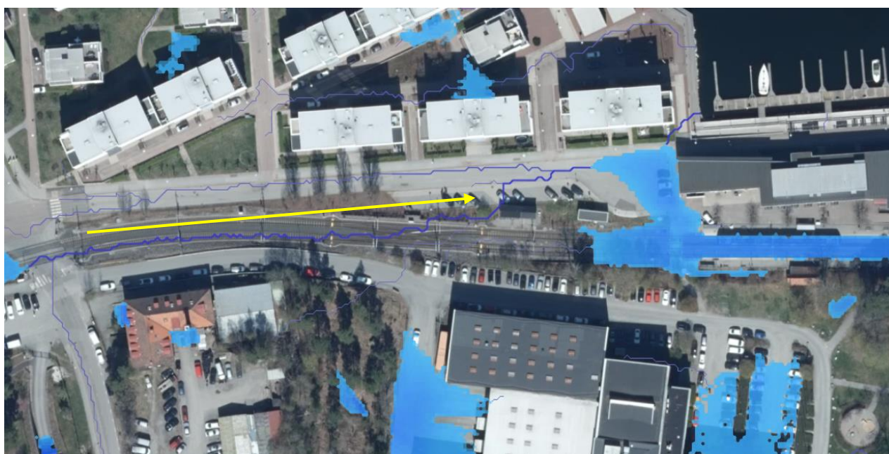
Figur 7 Ytliga avrinningsvägar (mörkblå streck) vid 100-årsregn (Scalگو Live 2025). Övergripande avrinningsriktning visas med gul pil.
