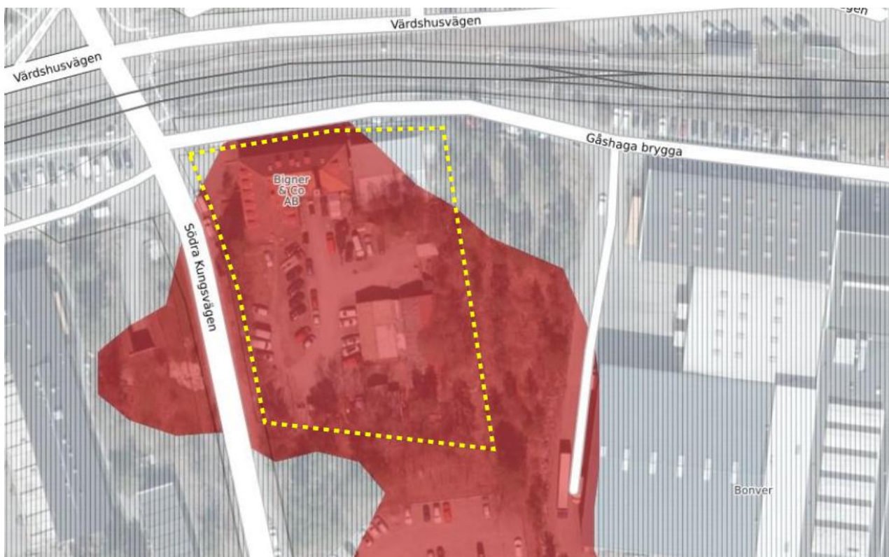
Figur 2 Jordartskarta från SGU. Utredningsområdet markerat med gult. Röda fält utgörs av urberg och gråstreckade av fyllnadsmassor.
