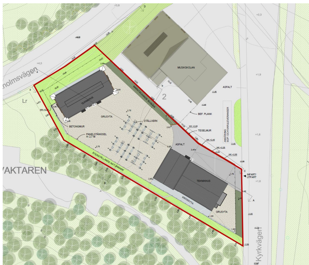
Illustrationsplan som visar förslag till utbyggd fördelningsstation (markerad med röd linje).
