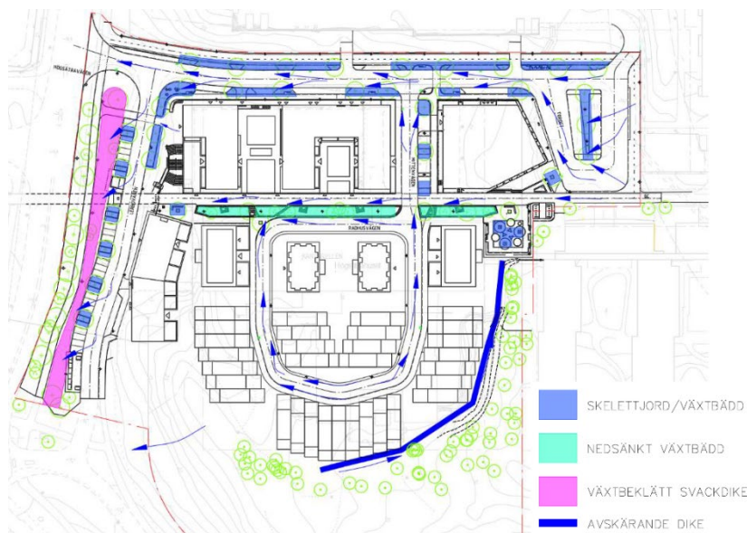
Schematisk skiss över föreslagen dagvattenhantering på allmän platsmark. Blå pilar visar avrinningsriktning mot olika typer av ytor för lokalt omhändertagande av dagvatten. Bild: Dagvattenutredning, Ramboll.
