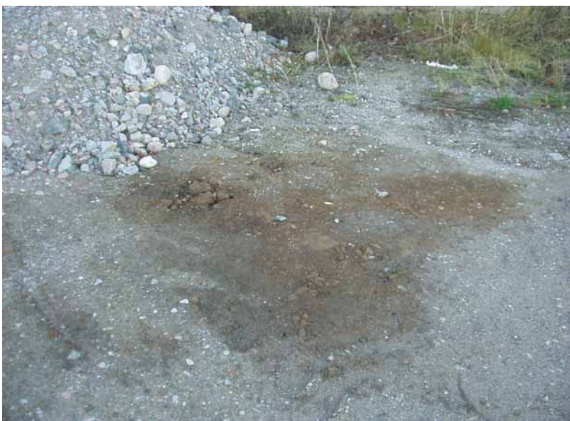
Figur 5. Rostfärgad gjuterislagg och -sand som deponerats och därefter täckts över.
