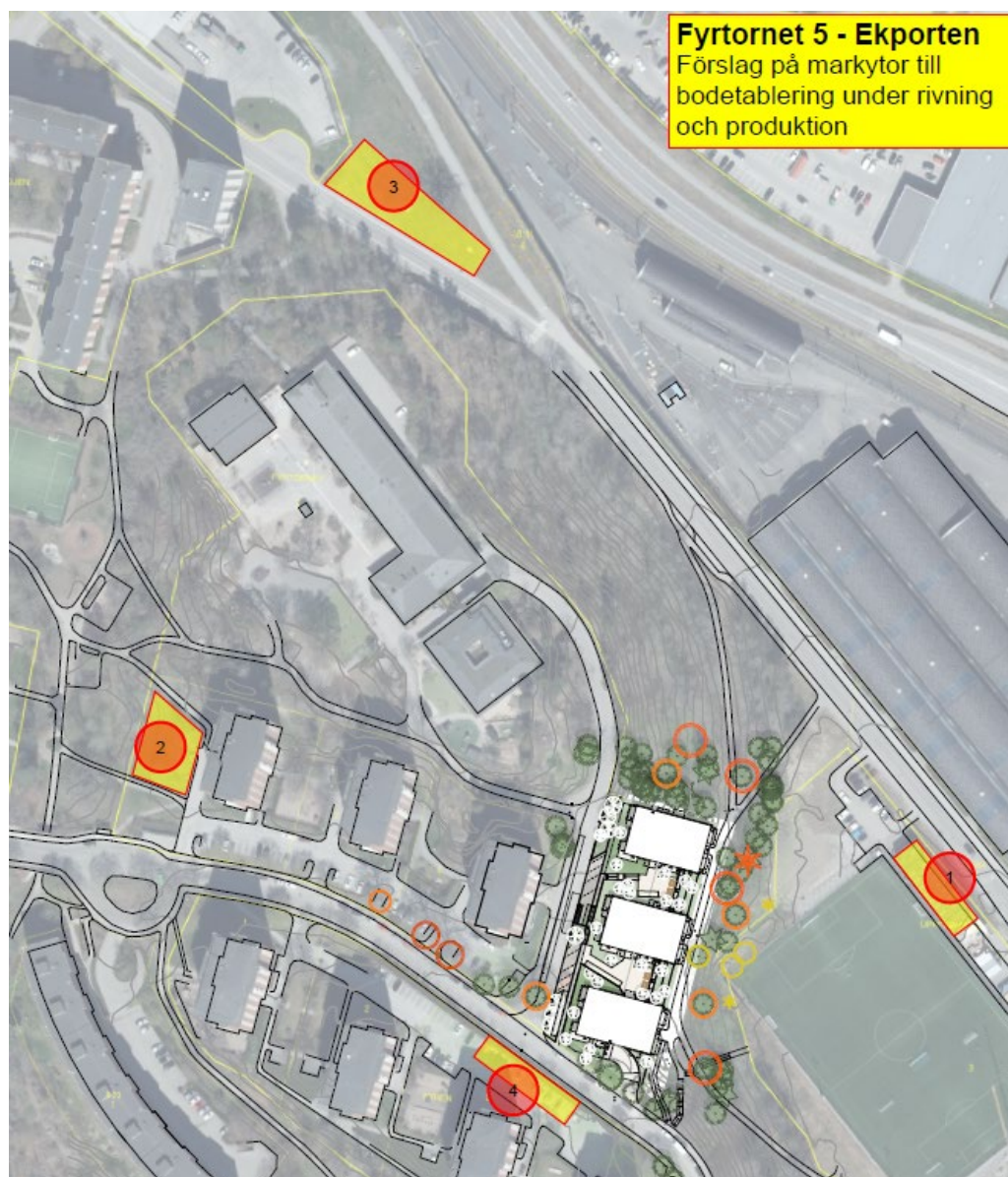
Bilden visar olika förslag på markytor för byggbodan under rivning av garaget och byggnation av de nya flerbostadshusen. Bild: SLB.
