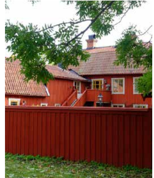
Träplank med locklister och profilerad överligger.
